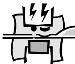
1-2 TRENNSEAL 1 x 3,5 mm seal 1 x 1,1 mm afsnij aparte tijdsinstellingen
