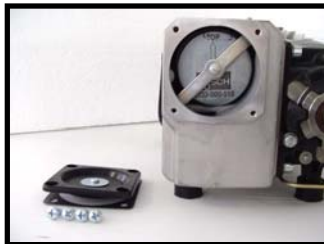
De filter(s) is zichtbaar en zit vast achter een spanner
