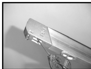
Trekdraden strak aan met behulp van een tang en bankschroef en schroef draden vast in klemplaat
