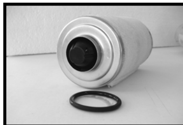
Let op dat de afdichtring van de filter niet achter blijft bij uitnemen filter
