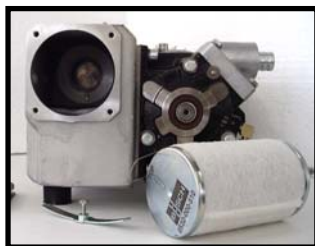
Neem spanner(s) en filter(s) uit behuizing
