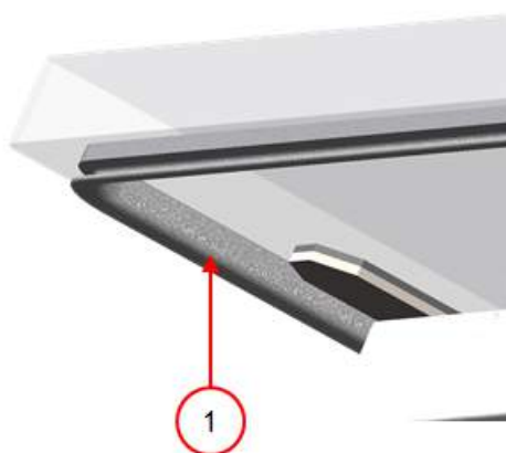
Figura 16: Sustitución de la junta de la tapa
