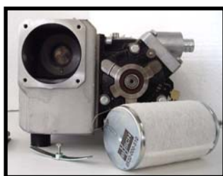
Neem spanner en filter uit behuizing
