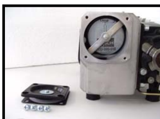
De filter is zichtbaar en zit vast achter een spanner
