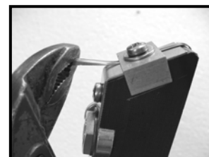
Trek draad strak aan met behulp van tang en bankschroef en Schroef draad vast in tweede klemplaat
