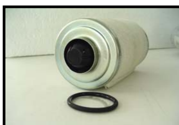
Let op dat de afdichtring van het filter niet achter blijft bij uitnemen filter
