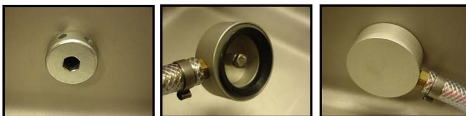
2. Placez le raccordement du tuyau sur l'orifice d'aspiration de la machine
