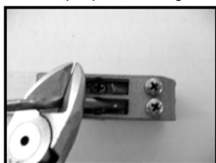
1. Sortir la barre de soudure de ses supports dans la chambre au moyen du système de clips.
