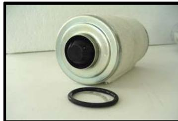
Assurez-vous d'enlever également le joint d'étanchéité du filtre en ôtant le filtre
