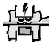
Après la fin de la fonction sous vide ou d'injection de gaz (si installées) la fonction soudure commence la soudure du (des) sachet(s) sous vide.
